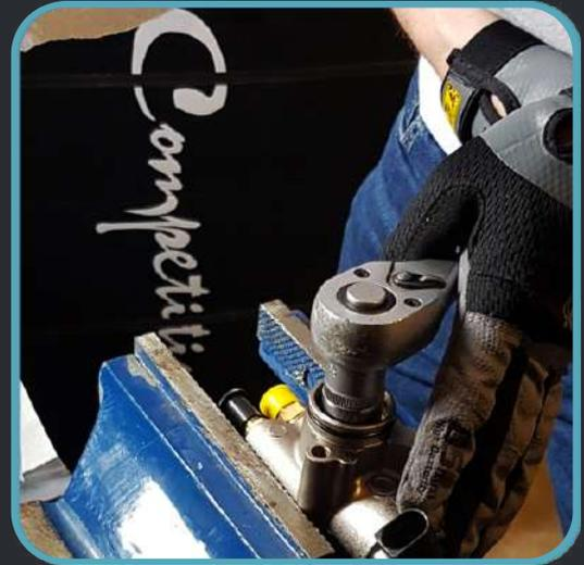
À l'aide de la douille allongée, desserrez et retirez l'écrou de maintien du piston.
