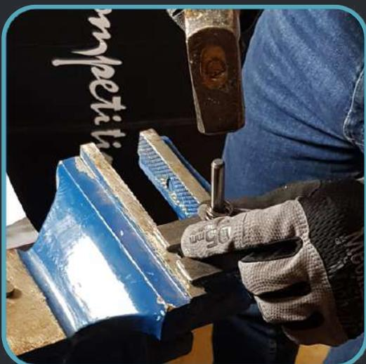
D'un coup de marteau sec, de faible amplitude, retirez la rondelle à mater de la tête du piston.
