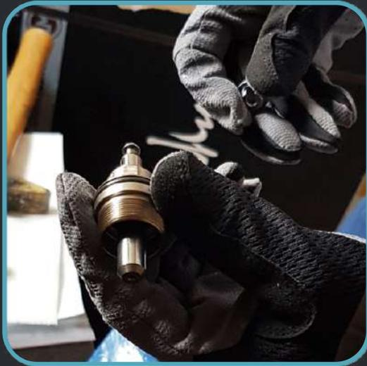
Faites glisser le piston dans la vis de maintien par le dessus. Posez par-dessus le ressort et la rondelle.
