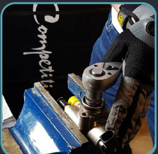
À l'aide de la douille allongée, serrez fortement l'écrou.
