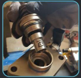
Dans un environnement propre, lubrifier le bas du piston pour y insérer sa bague. Repositionnez le tout dans la pompe.
