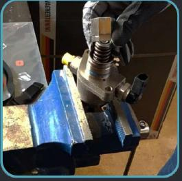
Calez votre pompe dans l'étau. Insérez l'outil de dévissage fourni : la partie la plus étroite vers le bas. L'enfoncer jusqu'au bout.
