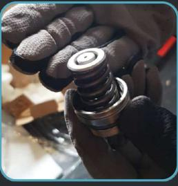
Une fois le piston assemblé correctement, il n'y a pas de jeu dans le ressort et le montage est conforme à celui d'origine.
