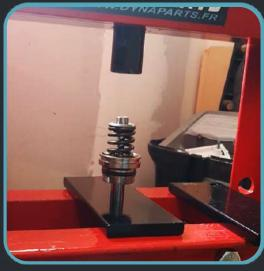
Posez le bas du piston sur une cale. Présentez l'axe de la presse directement en contact avec la rondelle de maintient.
