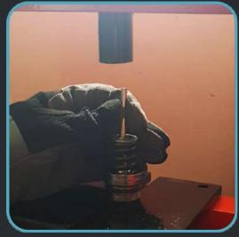
À l'aide d'un pointeau et de la presse éjectez la tige vers le bas pour la dégager de sa bague de maintient.
