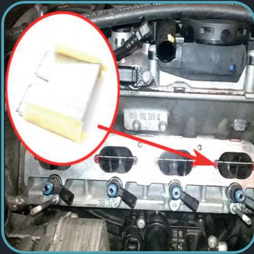
Démontez le collecteur d'admission proprement. Retirez ensuite de la culasse les 4 plaques canalisatrices d'air.
