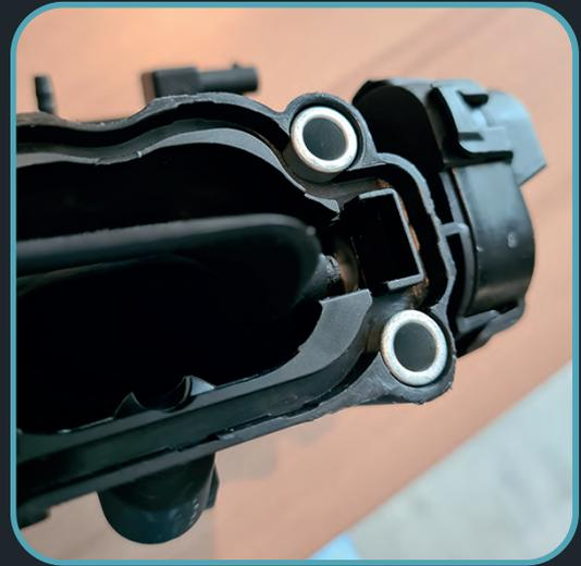
Dégagez la tige d'entraînement des clapets (du côté du poussoir actionneur). Retirez la tringlerie en commençant par ce côté.
