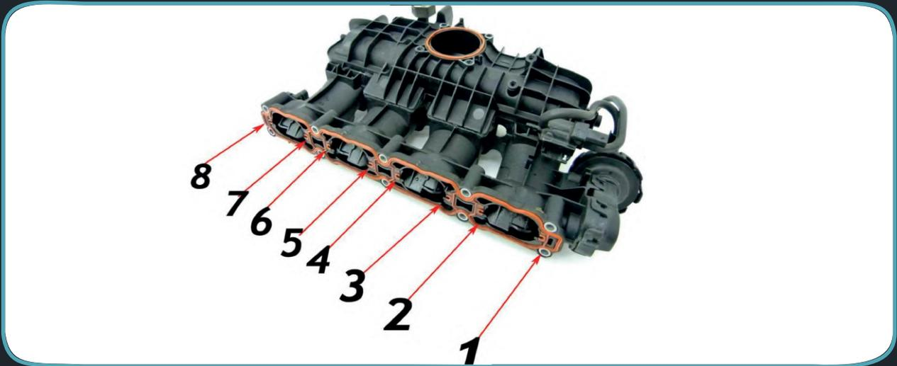
Une fois la tringlerie et les clapets sortis, positionnez les bouchons dans l'ordre de leurs numéros. Ils sont rangés dans des pochettes numérotées. Respectez l'ordre en démarrant la pose par le côté du poussoir actionneur. Fiez-vous au schéma ci-dessous.
