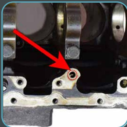
Percer le à l'aide du foret de 10mm pour élargir le trou. Retirer le gabarit. Tarauder le trou et y insérer l'insert helicoidale.
