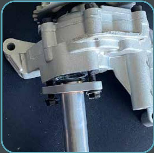
Installer la crépine en s'assurant de la bonne position du joint torique. Serrage 10Nm.
