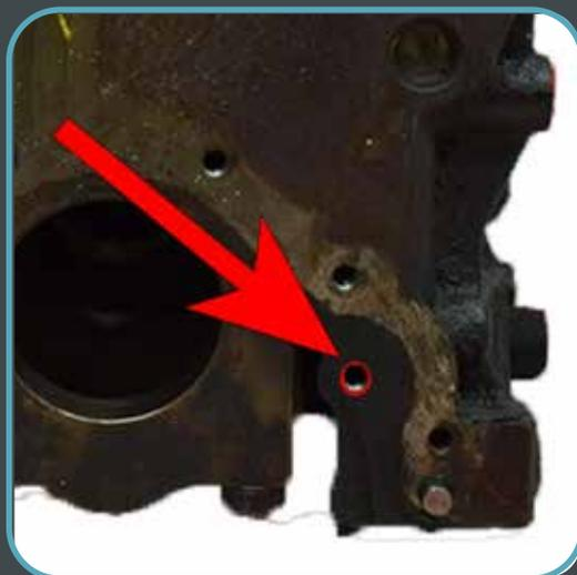
Percer le à l'aide du foret de 6mm pour élargir le trou. Retirer le gabarit. Tarauder avec le taraud fourni de 7mm.
