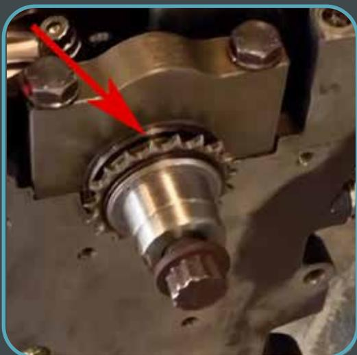
Chauffer la couronne dentée d'origine avec une torche puis l'extraire. Chauffer à 150°C-la nouvelle couronne et l'insérer à la place.
