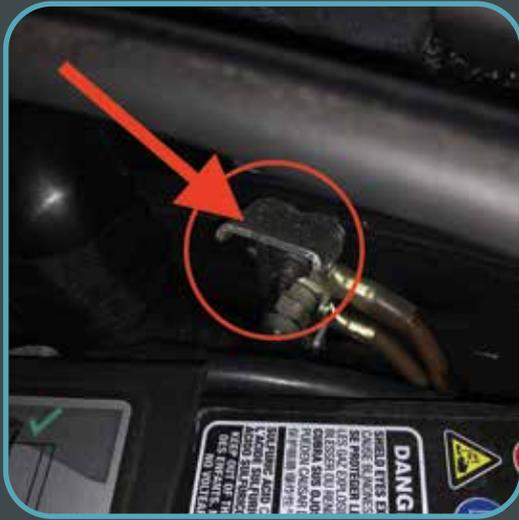
Repérer la masse à gauche de la batterie, dévissez là avec une douille de 10 mm puis retirez le câble de la masse et connectez-y le connecteur de masse du faisceau. Reconnectez la masse puis procédez au remontage.
