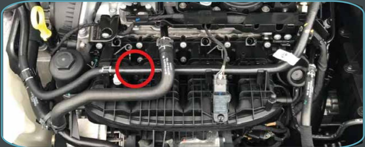
Enlever le cache moteur, localisez la conduite de carburant sur laquelle vous allez monter le capteur. Nous vous recomendons de découper la durite à cette endroit et d'y insérer le capteur.
