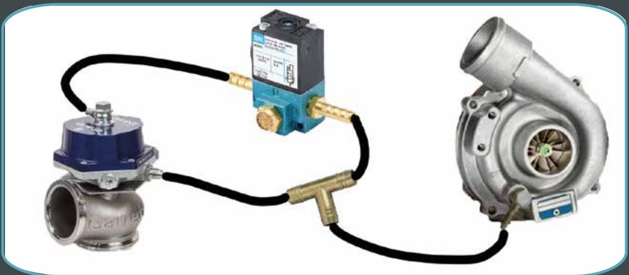
Suivez les connexions comme indiquées sur le schéma si vous disposez d'un turbo avec wastegate externe. Connectez les raccords sur l'emplacement 1 et 2 puis le filtre sur l'emplacement 3.
