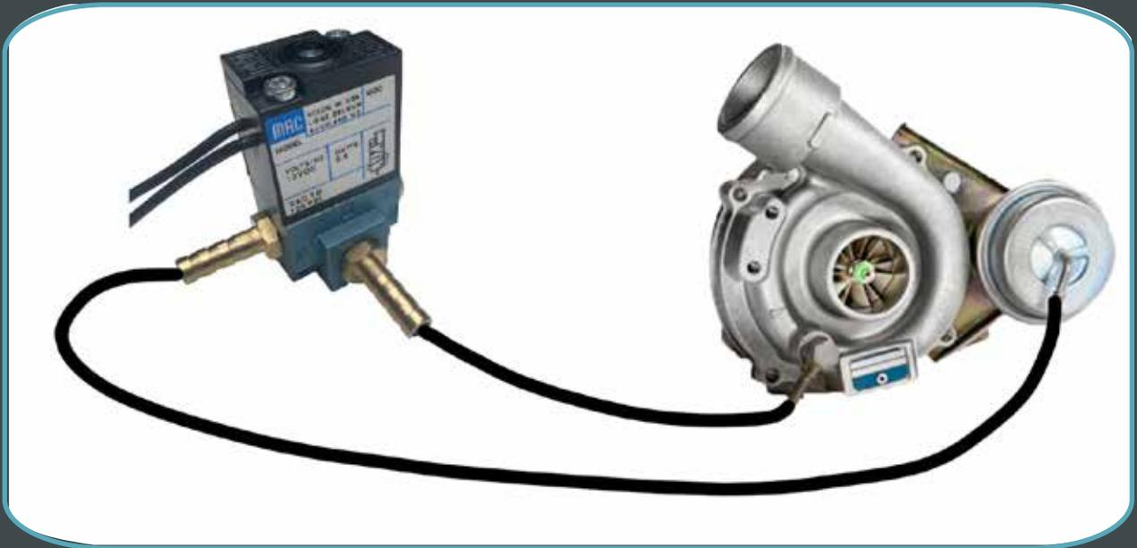
Suivez les connexions comme indiqué sur le schéma si vous disposez d'un turbo avec wastegate interne. Connectez les raccords sur l'emplacement 2 et 3 puis le filtre sur l'emplacement 1.
